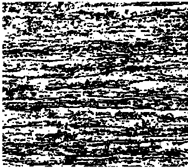
FIGURA 6. La microestructura de granos alargados de un acero al 0.10% de carbono, laminado en frío (1000X) (con permiso de Metals Handbook , volumen 7, copyright American Society for Metals, 1972).
